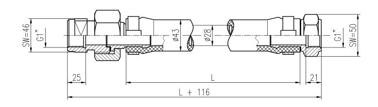
Prüfung und Abnahme: Auf Dichtheit mit 8 bar Prüfdruck.
